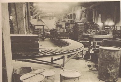
อุปกรณ์ลำเลียงแบบรถถังที่ทันสมัย Modern roller conveyors for mould transport
