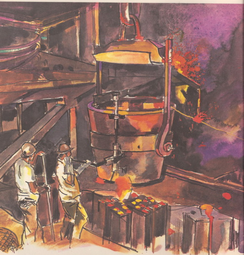
ส่วนหนึ่งของงานแต่ละวัน ได้แก่การหล่อเหล็กแท่ง Ingot casting
