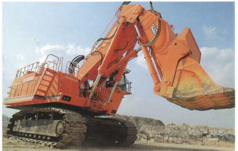
รถขุดฮิตาชิ รุ่น ฮีเอ็กซ์ 3500 ซึ่งเป็นรถขุดขนาดใหญ่ที่สุดในประเทศไทย จากการนำเข้าของบริษัทสยาม-ฮิตาชิ คอนสตรัคชั่น แมชีเนอรี จำกัด ขณะกำลังใช้งานที่โครงการเขาวง 1 ของบริษัทปูนซีเมนต์ไทย จำกัด
