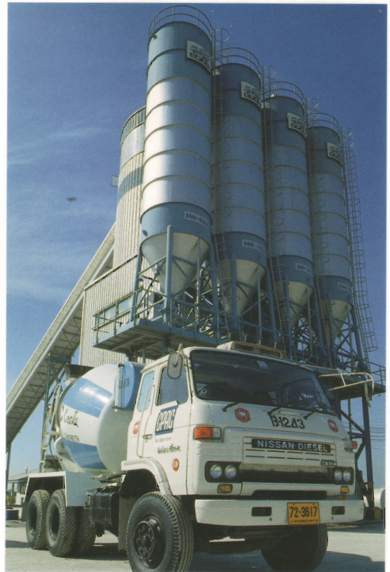
บน: ระบบทาวเวอร์แพลนท์ (Tower Plant) เป็นเทคโนโลยี การผลิตคอนกรีตผสมเสร็จที่บริษัทผลิตภัณฑ์และวัสดุก่อสร้าง นำมาใช้เป็นรายแรกในประเทศไทย เพื่อป้องกันมลภาวะ ด้านฝุ่นและเสียง
